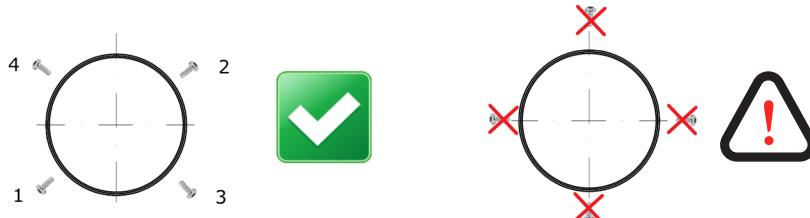
4.1 pav. Ortakiu ir fasoninių dalių pajungimas prie drékintuvu (draudžiama sukti savigręžius ties horizontaliai ir vertikaliai ašimis – tai gali pažeisti vidinius drékintuvu
